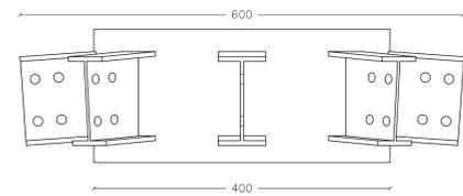
ELEMENTO DI RACCORDO CENTRALE: SEZIONE C-C
